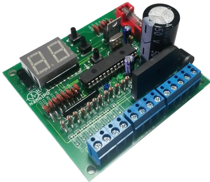
O kit NanoIPD foi desenvolvido para usar a tecnologia WT nos indicadores de posição digital da WT Comandos em qualquer tipo de elevador, o Microcontrolador usado é o PIC da Microchip, que tem uma excelente qualidade e eficiência para circuitos eletrônicos de baixo custo.
